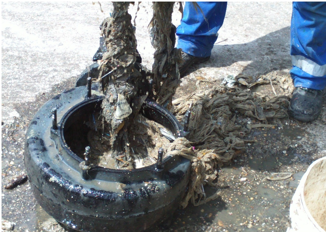
átelő szivattyú meghibásodása szálal anyag miatt
